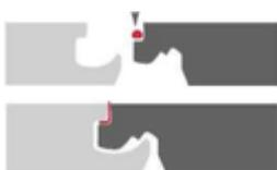
Feuchtigkeit/Flüssigkeit zu rechnen ist, wird eine Versiegelungsverleimung mit PVAC Leim (D3) notwendig. Den Versiegelungsleim so auf die stirn- und längsseitige Feder auftragen, dass dieser beim Zusammenfügen der Elemente über die gesamte Länge der Verbindung nach oben austritt. Überschüssiger Versiegelungsleim kann sofort oder nach kurzem Antrocknen von der Oberfläche entfernt werden.
